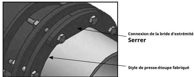
9. Assurez-vous que les sections du manchon et de la bague d'extrémité fendue sont concentriques sur le tuyau et par rapport au joint fendu/de verrouillage à clé.
