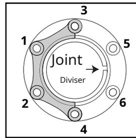
11. Serrez les boulons de serrage du joint latéral à 90 lb-pi en travaillant à l'intérieur/à l'extérieur en suivant deux fois le couple d'installation, en répétant la même séquence que celle expliquée à l'étape numéro 5.
